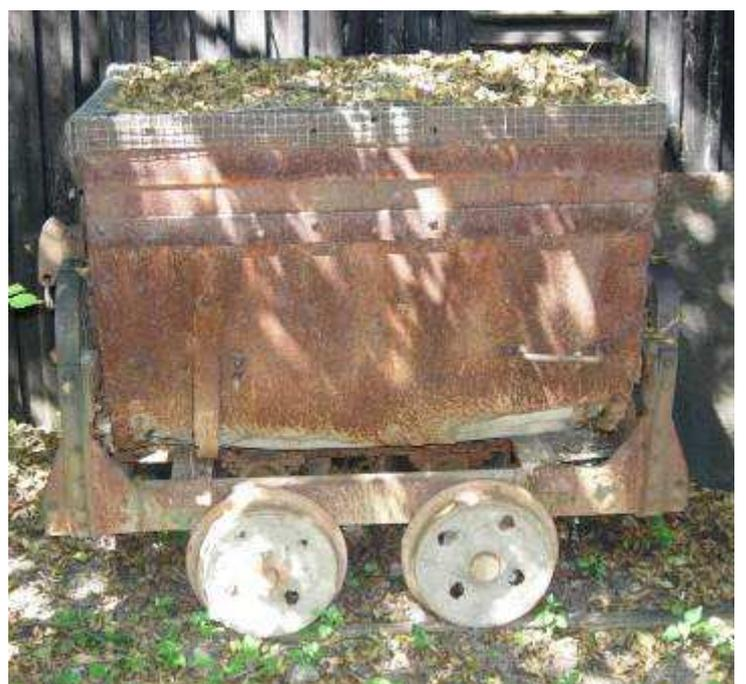
*Petit wagonnet à benne ayant servi à transporter en galerie les blocs à coticule et les déchets jusqu'au « tonneau ». (musée du coticule)*
