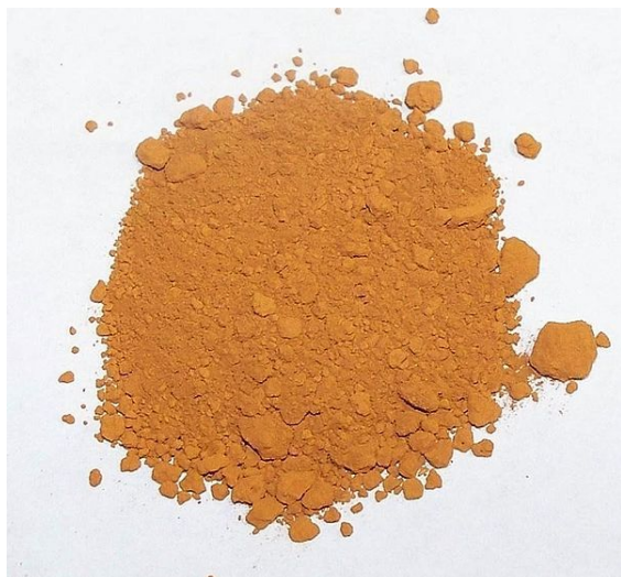
Pure gold precipitate produced by the aqua regia refining process
