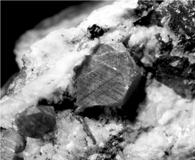
fig. 7.7 striaties ten gevolge van tweelingvlakken in korund langs deze vlakken kan valse splijting optreden
