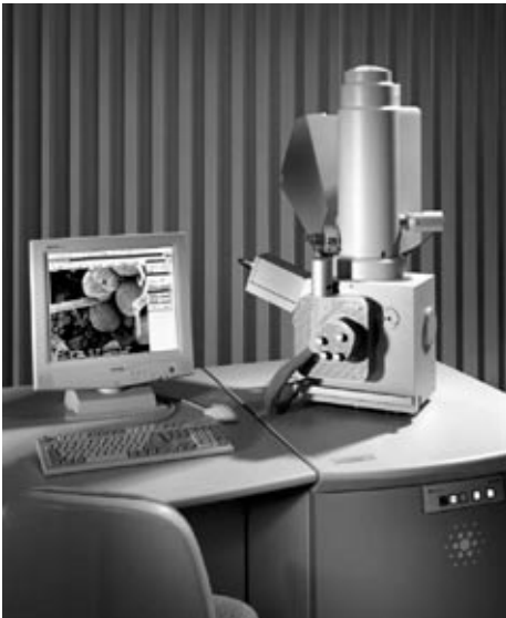
fig. 11.4 een actuele rasterlektronenmicroscop [bron: FEI Company, instrument: Sirion]
